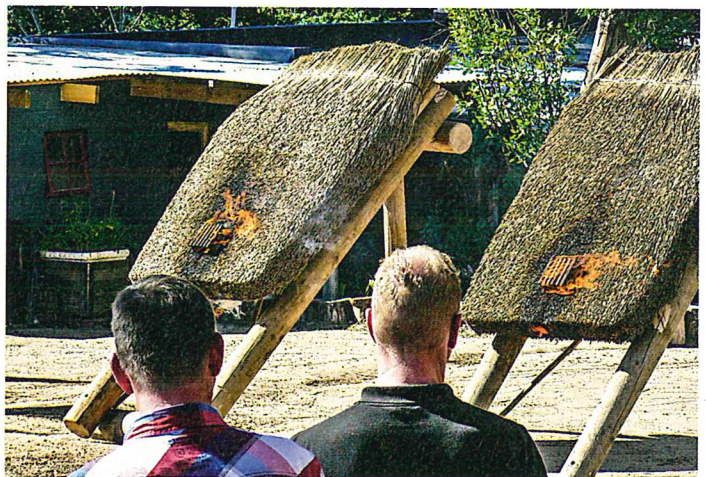
Zum Konferenzprogramm gehörten auch Brandtests an unterschiedlichen, vorgefertigten Musterflächen.
